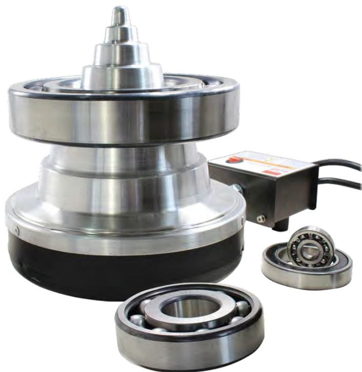
Le chauffage permet aux paliers de prendre l'expansion pour les ajuster avec précision sur l'arbre sans dommage. Installer un palier froid sous pression sur un arbre peut entraîner un mauvais alignement du palier et une différence dans la position du palier aussi petite que 0,001 po peut réduire sa durée de vie de 50 %.
